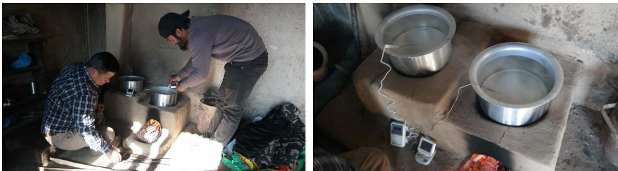
Vorbereitung der Water Boiling Tests
