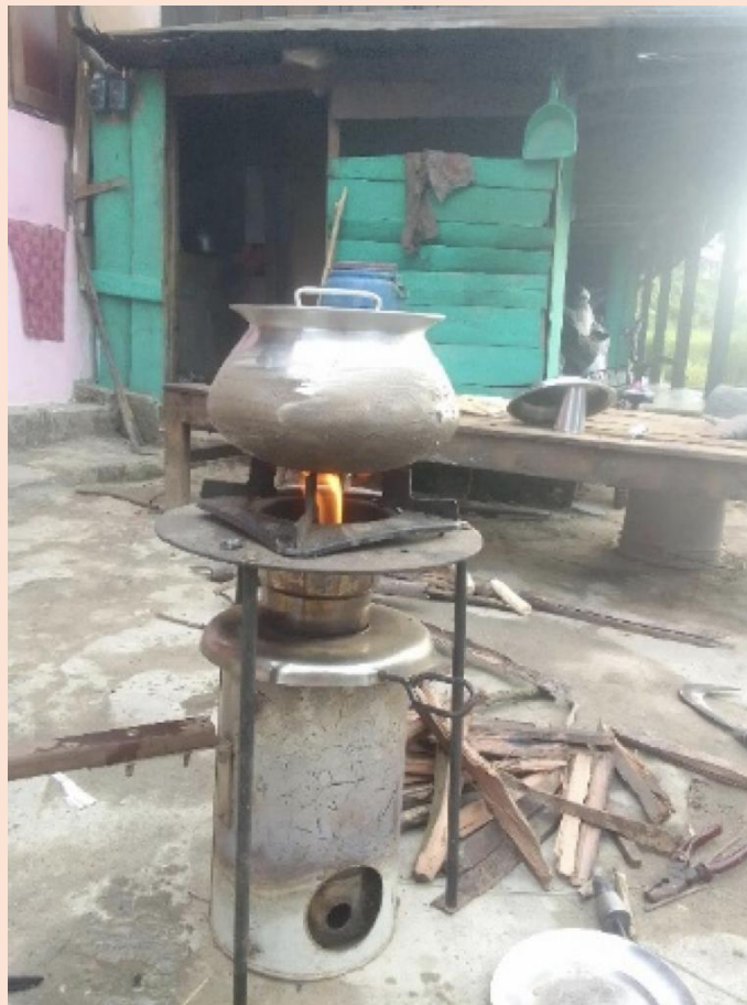
TLUD-Ofen im Betrieb
